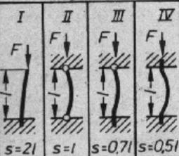
Lange, schlanke Bauteile, wie Stützen, Kolbenstangen, Pleuel, die man in Längsrichtung auf Druck beansprucht, können seitlich ausknicken.
