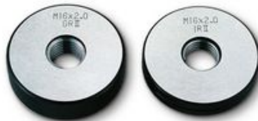
Thread Limit Ring Gauge (Gewindelehrring)
